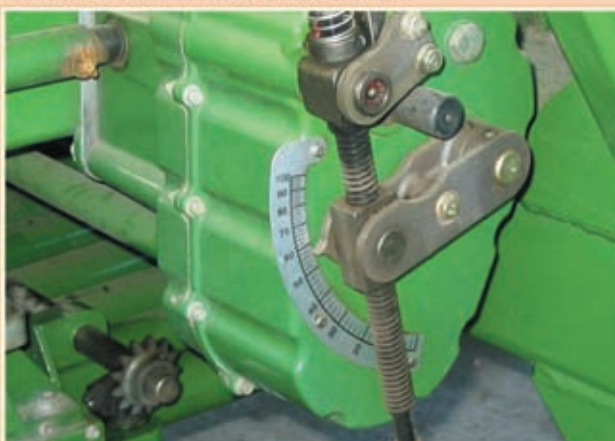
Variador electromecánico en tolva air drill
